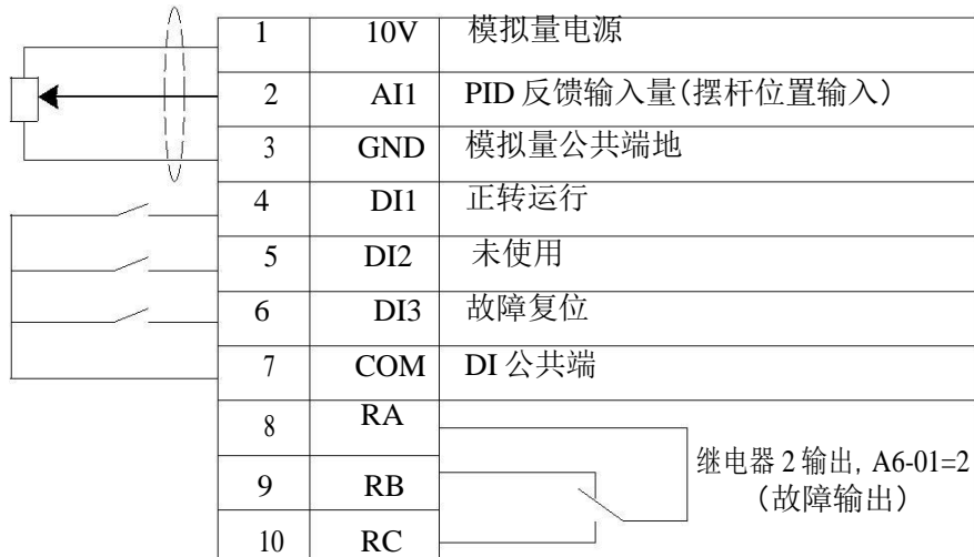
图 5.1 张力收卷接线示意图
